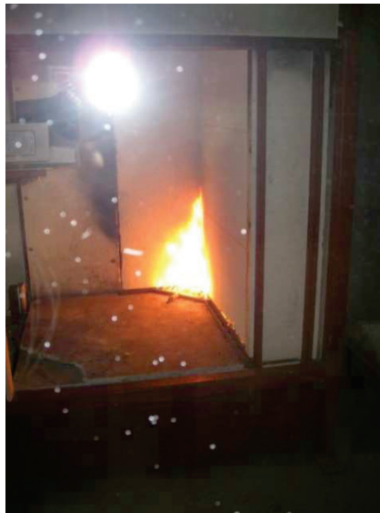
2.7. att. Ugunsdrošības pārbaudes (Joma Renārs Pētnieciskais darbs ETAG 004 normu ietekme uz siltināšanas kvalitāti. 2011.g.)
