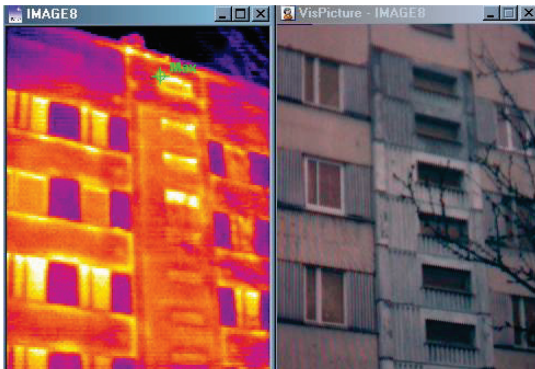
6.4. att. Siltuma zudumi caur logiem. ( SIA JNTP arhīvs)
