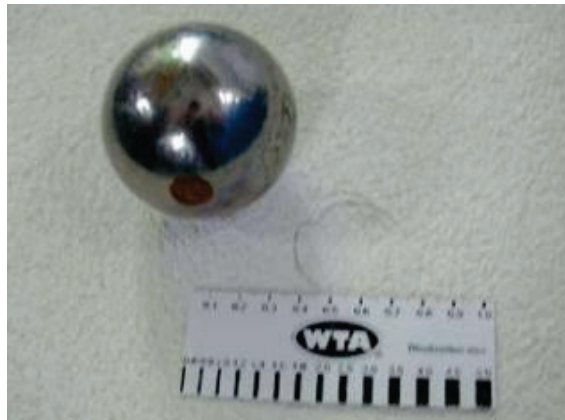
2.8. att. Stipru sitienu pārbaude (Joma Renārs Pētnieciskais darbs ETAG 004 normu ietekme uz siltināšanas kvalitāti. 2011.g.)
