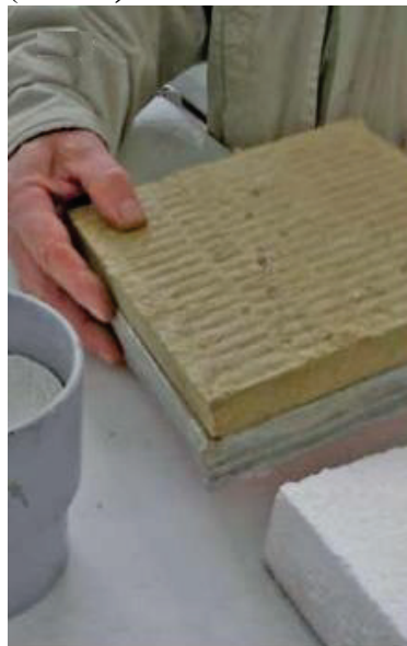
2.9. att. Ūdens tvaiku caurlaidības pārbaude (Joma Renārs Pētnieciskais darbs ETAG 004 normu ietekme uz siltināšanas kvalitāti. 2011.g. )
