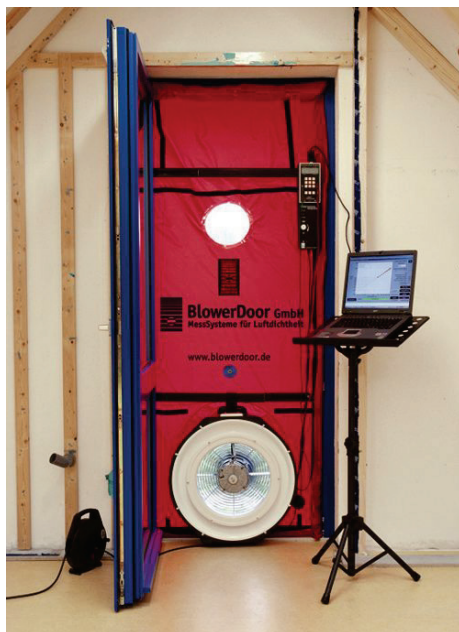
9.8. att. Blower Door iekārta (Blower Door GmbH)
