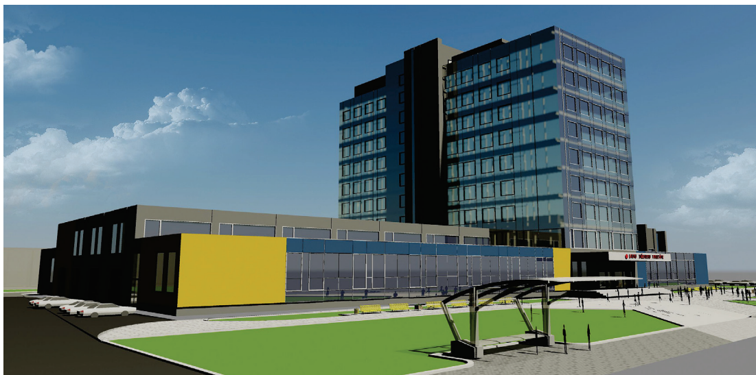
4.4. att. LLU Lauku Inženieru fakultātes laboratorijas korpusu siltināšana, izbūvējot jumta zonā saules enerģiju uzkrājošus elementus un fasāžu stiklojuma paneļus ar saules enerģijas akumulējošā stiklojuma apdari. (A. Ziemeļnieces projekts)
