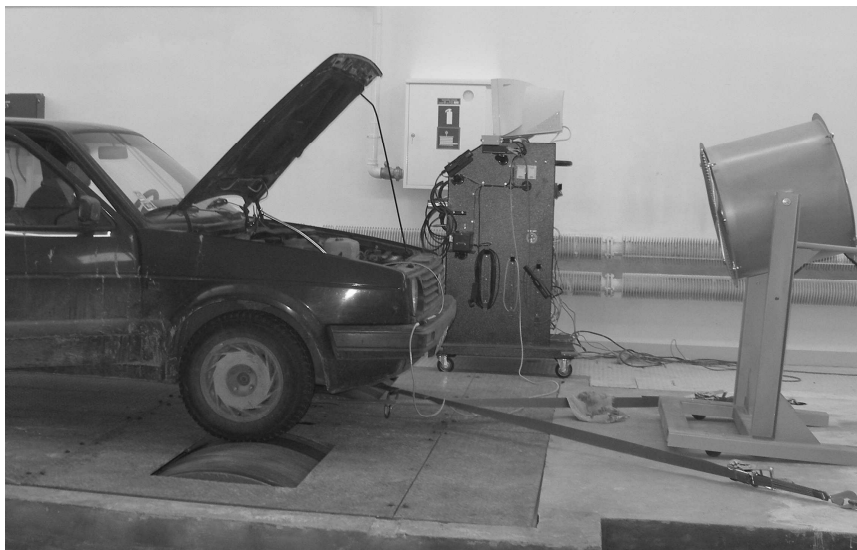
5. att. Automašīna izmēģinājumi uz rullu stenda Biodegvielu zinātniskajā laboratorijā (Jelgava, Paula Lejiņa ielā 2)
