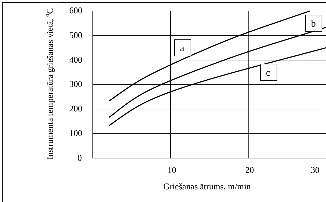
13.1.att. Temperatūru atšķirība metālgriešanā: a – sausā griešana, b – dzesēšana ar eļļu, c – dzesēšana ar eļļas-ūdens emulsiju.
