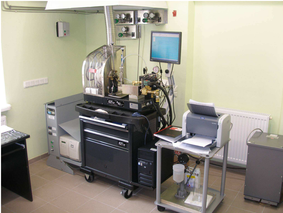
7.4.att. Stanhope-Seta (UK) ražotā cetānskaitļa noteikšanas iekārta.
