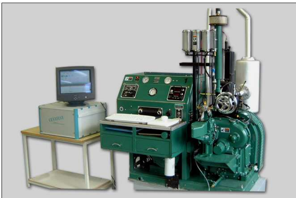
7.3.att. ASV ražotā cetānskaitļa noteikšanas iekārta.
