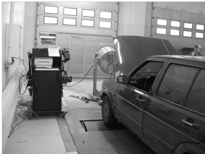
22. att. Spēkratu izmēģināšanas ruļļu stends MD-1750-DE, LLU Biodegvielu un motoru zinātniskajā laboratorijā.
