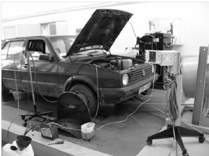
25. att. Automobiļa testēšana uz ruļļu stenda MD-1750 LLU Biodegvielu un motoru zinātniskajā laboratorijā.
