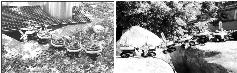
18. att. Autosaliekamo robotu sabiedrība kopīgi vieglāk pārvar šķēršļus (avots: EU-IST projekts, Šveice, 2003)
