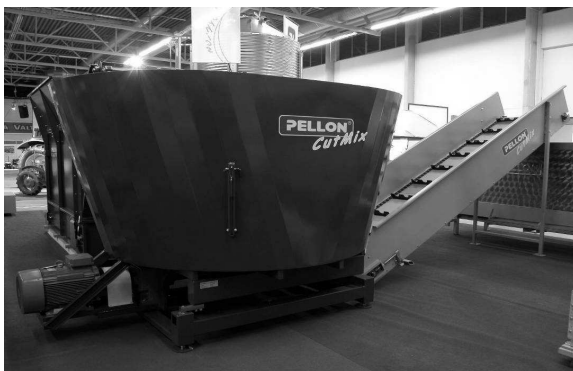
9. att. Lopbarības maisījuma sagatavošanas tilpne ar tajā iemontētu vertikālu gliemezi. Šim gliemezim ir piemontēti naži, kuri kalpo rituļos sagatavotās barības smalcināšanai
