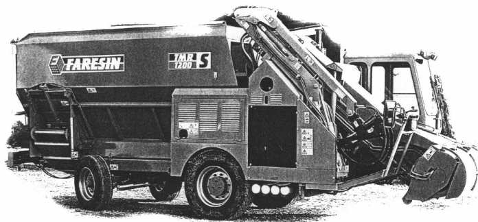
5.5. att. Pašbraucošs lopbarības maisītājs izdalītājs ar tenzosvariem un lopbarības iekraušanas frēzi.
