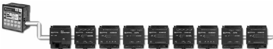
4.25. att. Ieeju un izeju skaita palielināšana Vision 120 kontrollerim
