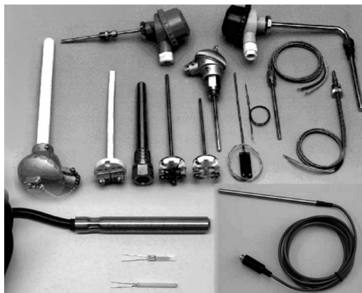
4.2 att. Rezistīvo temperatūras sensoru konstruktīvā izpildījuma veidi
