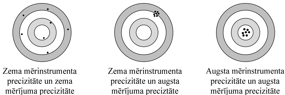
2.1 att. Mērinstrumenta un mērījuma precizitātes salīdzinājums
