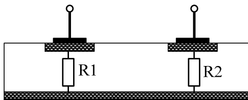
4.6 att. Simetriski veidota sensora uzbūve
