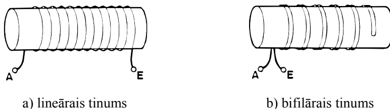
4.1 att. Lineārais un bifilārais tinums
