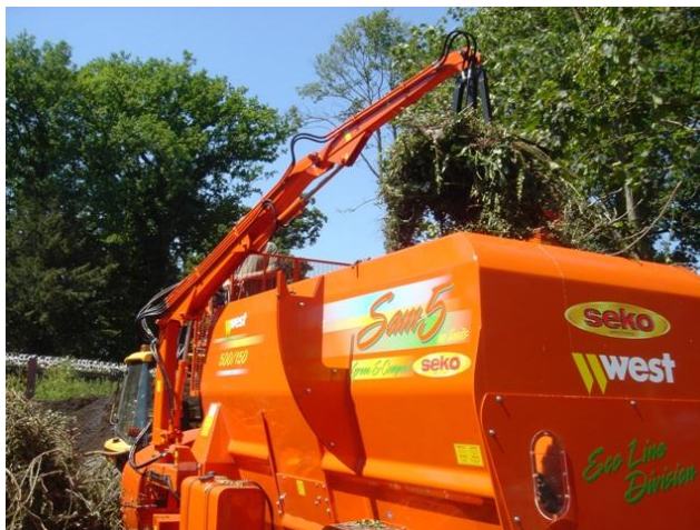
68. att. Smalcinātājs-maisītājs ar piebūvētu iekrāvēju
