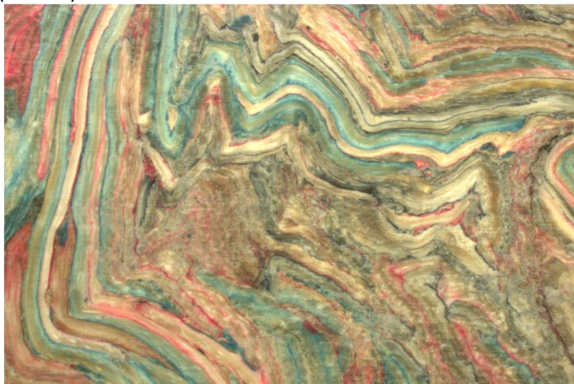
57. att. Orientētu niedru stiebru briketes šķērs griezumā
