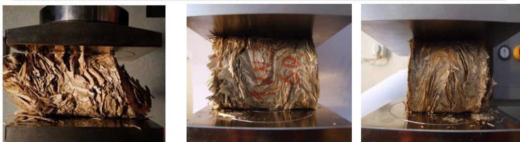
59. att. Brikešu noturības pārbaudes pielietojot spiedes metodi starp divām paralēlām plaknēm.
