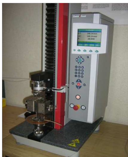
9.9. att. Zwick materiālu testēšanas iekārta
