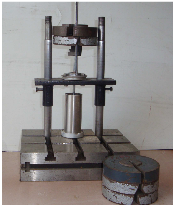
68. att. Iekārta kompaktēšanai ar fiksētu slodzi
