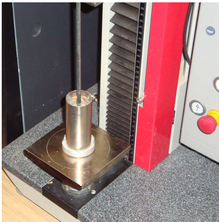
70. att. Sasmalcinātas niedru biomasas kompaktēšana ar Zwick TC-FR2.5TN.D09
