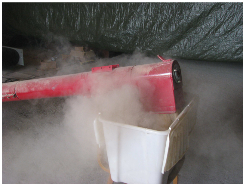
92. att. Glemežtransportiera radītie putekļi
