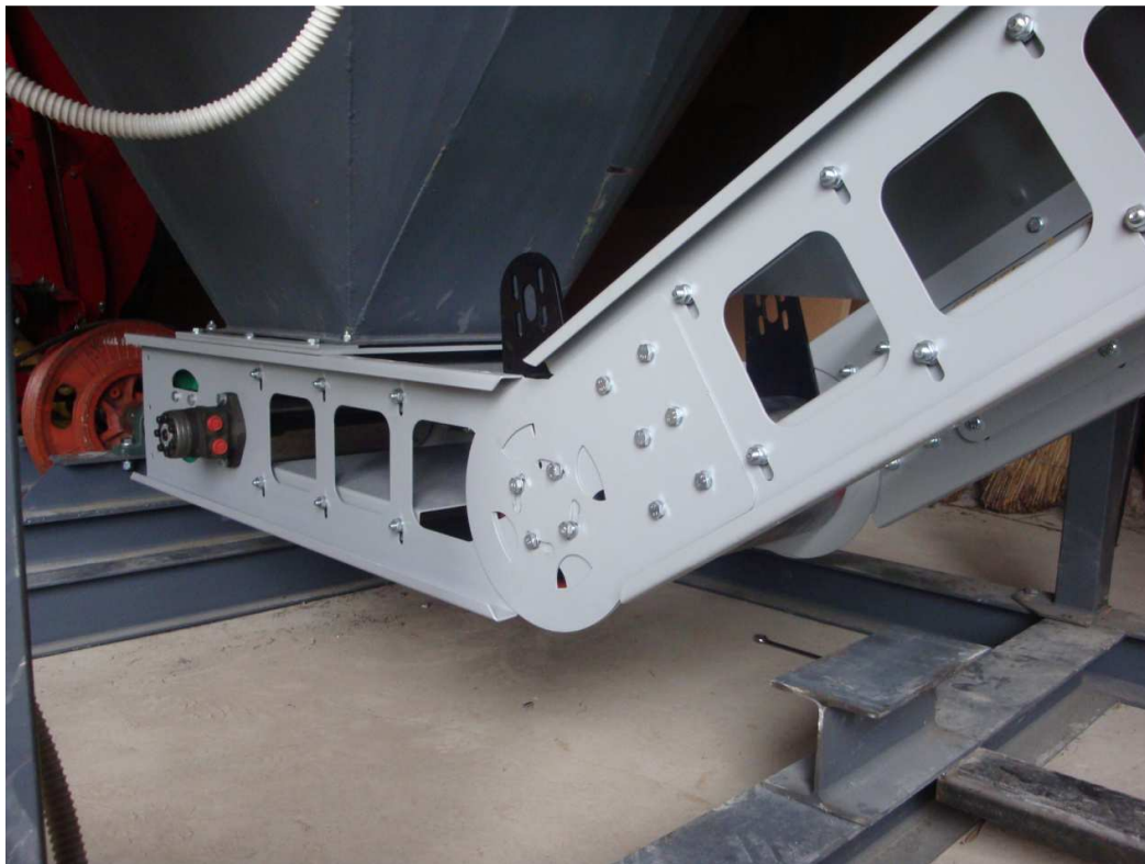
26. att. Transportēšanas mezgla montāža pie smalcinātāja prototipa
