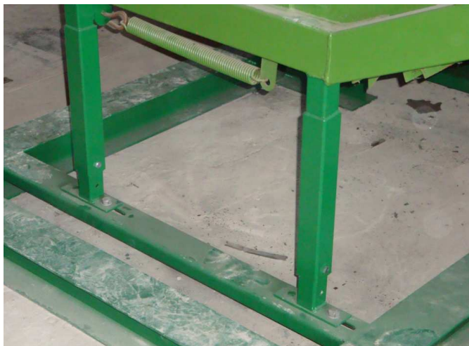
28. att. Ruļļu iztīšanas mezgla montāža pie smalcinātāja prototipa rāmja
