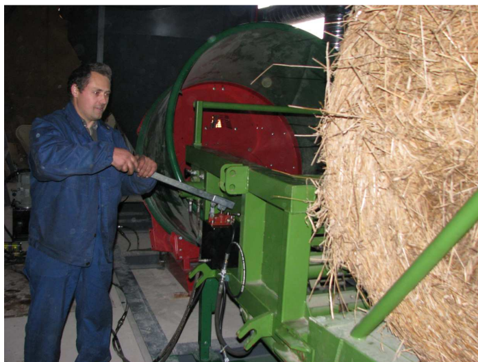
40. att. Ruļļu iztīšanas mezgla eksperimenti
