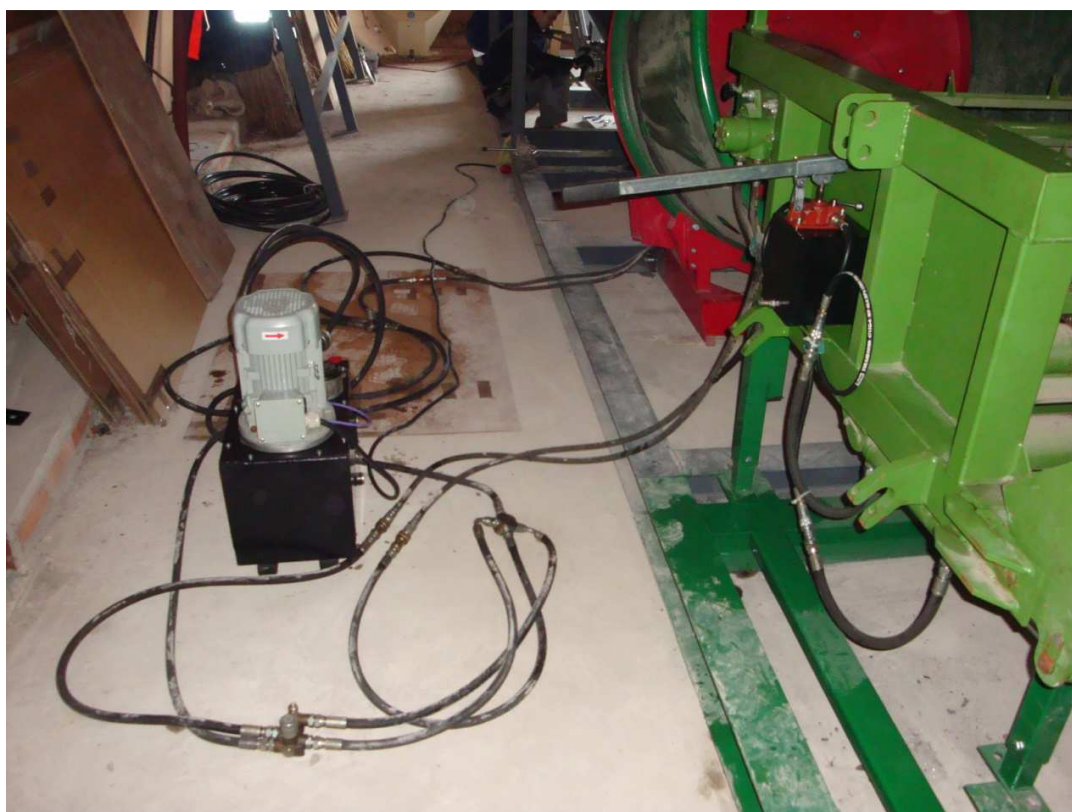
32. att. Smalcināšanas prototipa hidraulisko elementu slēgums (daļējs)
