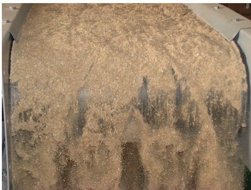
75. att. Smalcinātās masas izvietojums pa lentas platumu
