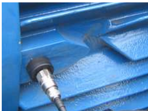
3. att. Sensors VIB 6.147 un tā nostiprināšana
