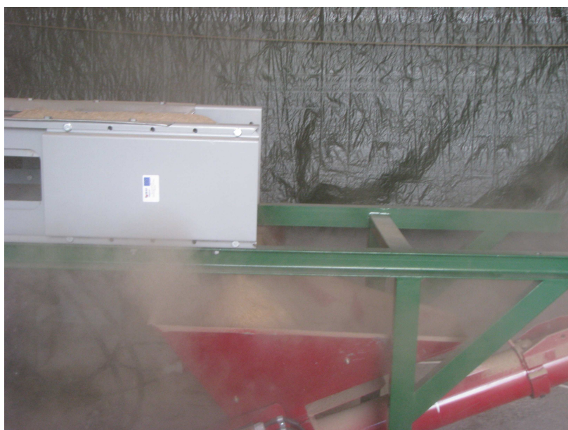
86. att. Putekļu veidošanās dozēšanas procesā
