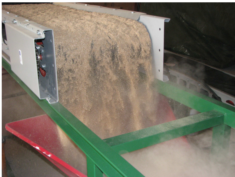
85. att. Putekļu veidošanās dozēšanas procesā
