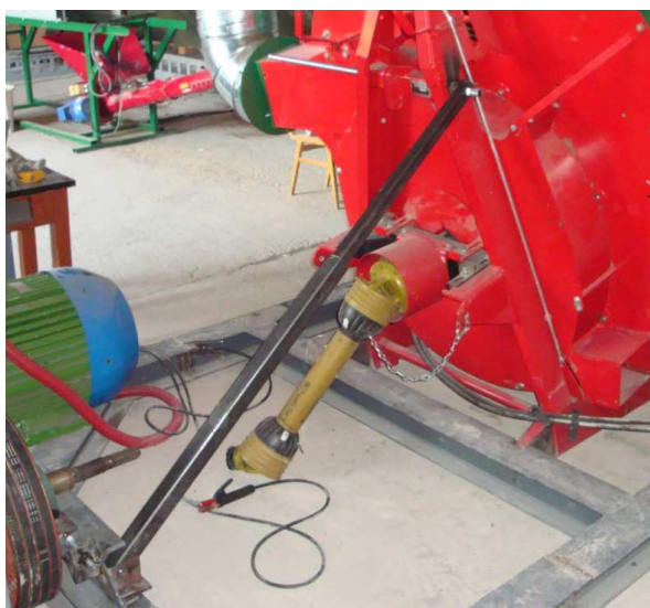
29. att. Ruļļu smalcināšanas mezgla slīpuma regulēšanas mehānisms
