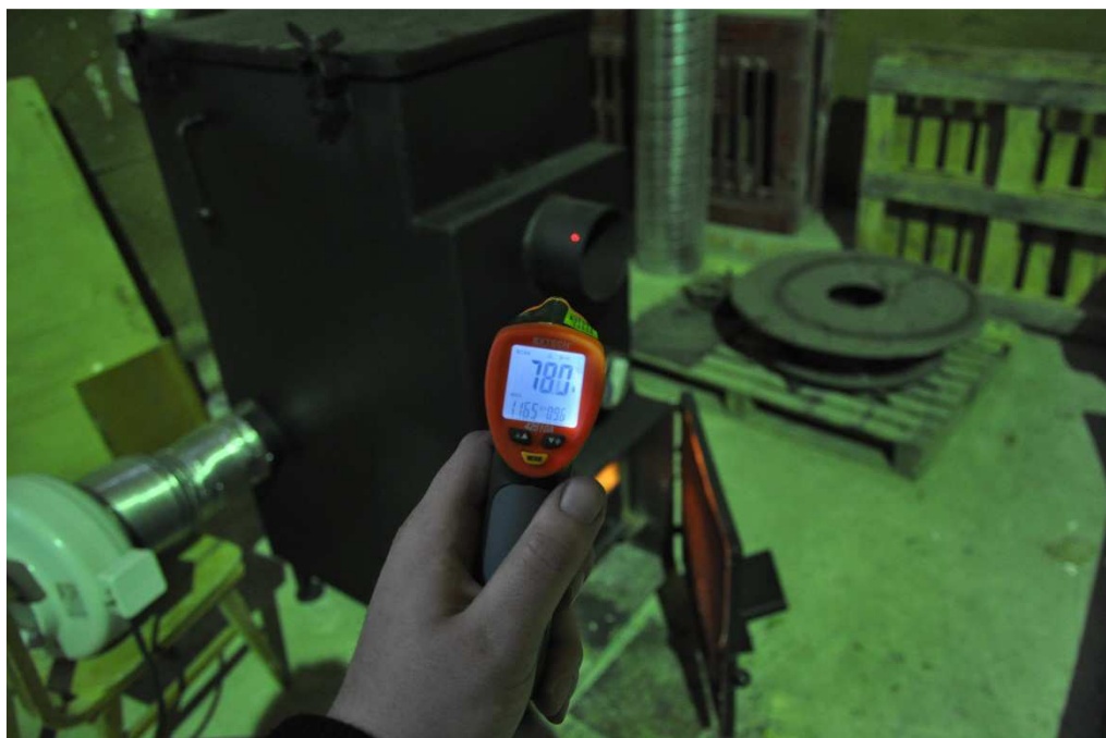
173. att. Temperatūras mērījumi funkcionālajā pārbaudē
