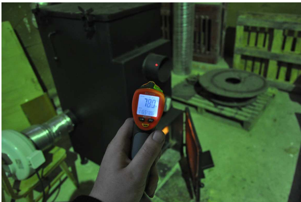
66. att. Temperatūras mērījumi funkcionālajā pārbaudē
