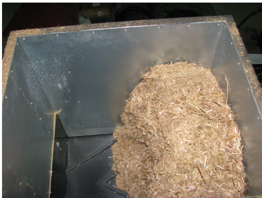
129. att. Masas izvietojums tvertnei iztukšojoties
