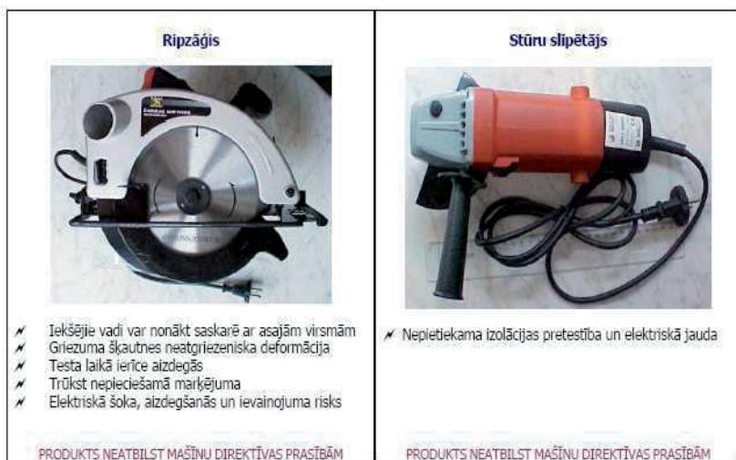
5.4.att. Drošības prasībām neatbilstošs ripzāģis un stūru slīpētājs
