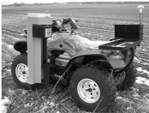
36. att. Kvadricikls YFM 660 ar iekārtu Wintex 1000 augsnes paraugu mehanizētai noņemšanai, iekārtu vietas koordinātu noteikšanai un fiksēšanai datu krātuvē un ar bortdatoru agregāta vadīšanai
