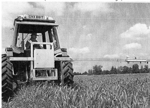
42. att. Uz traktora uzmontēta iekārta ar stieņa galā uzstādītu ultraskaņas ierīci augu stājmasas noteikšanai laukā.
