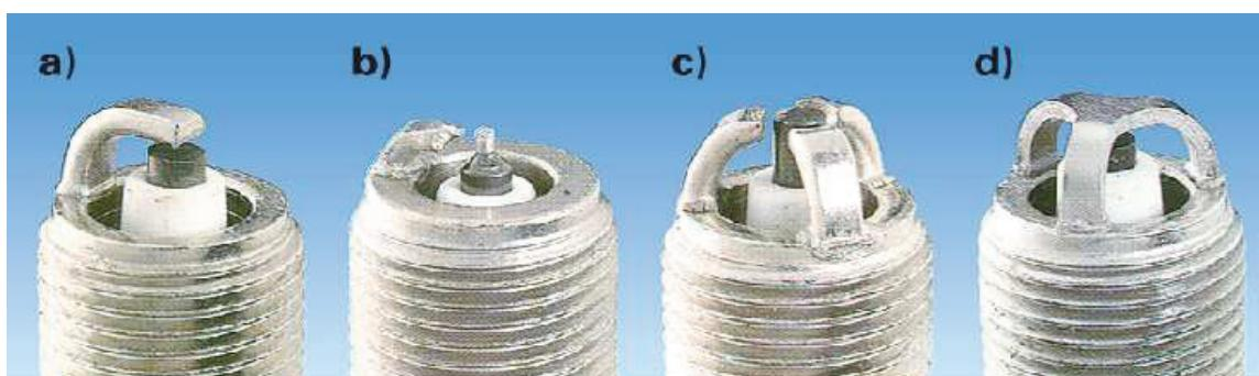
20. att. Aizdedzes sveces elektrodu konstrukcijas
