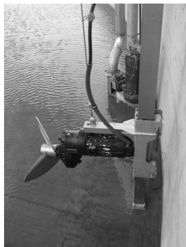
7.23.att. Lāpstiņu maisītājs (pa kreisi) un iegremdējams motora propellera dzinējs (pa labi) (AGRINZ GmbH, 2006)
