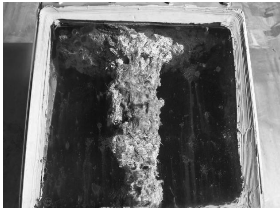
7.28.att. Vienkāršais sērs, kas radies bioreaktorā bioloģiskās desulfurizācijas rezultātā (RUTZ, 2007)
