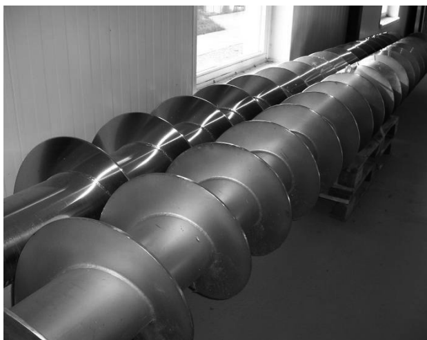
7.12.att. Skrūvveida caurules transportēšanas sistēma (pa kreisi) un uzstādīšanai gatavs skrūves tipa konveijers (pa labi) (RUTZ, 2007)
