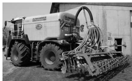
6.3.att. Pārstrādātā substrāta kā mēslojuma izplatīšanas tehnika ar joslu kļiedētājiem (AGRINZ GmbH)
