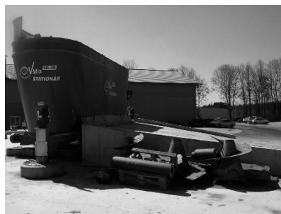
7.10.att. Padeves konteineru sistēma sausajām izejvielām – kukurūzas skābbarībai un cietajiem putnkopības kūtsmēsliem (pa kreisi) un iekrāvējs ar kukurūzas skābbarību (pa labi) (RUTZ, 2008)
