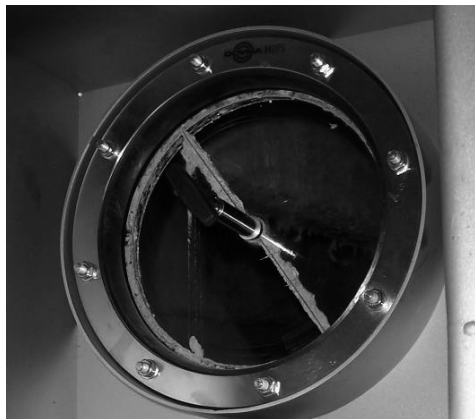
7.28.att. Vienkāršais sērs, kas radies bioreaktorā bioloģiskās desulfurizācijas rezultātā (RUTZ, 2007)
