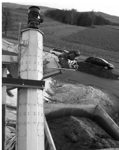
7.12.att. Skrūvveida caurules transportēšanas sistēma (pa kreisi) un uzstādīšanai gatavs skrūves tipa konveijers (pa labi) (RUTZ, 2007)
