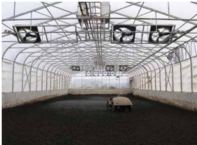
1.29.attēls. Digestāta žāvēšana ar siltu gaisu siltumnīcā. (Avots: http://joule.agrarheute.com/gaerrestrocknung-thermo-system )
