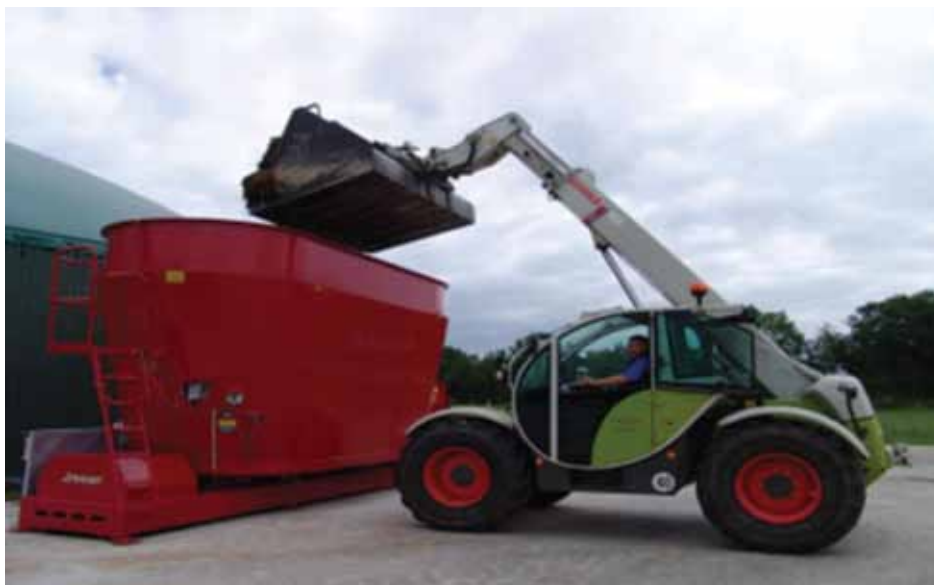
1.10.attēls. Cietās biomasas padeves iekārta ar sajaucēju.
