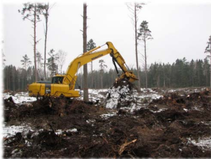
Att. 4 Celmu izstrāde A/s LVM Zemgales mežsaimniecības, Misas meža iecirkņā, 177 kv.
